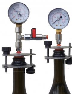
Афрометр, для контроля давления в процессе изготовления игристых вин.
